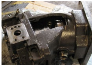
Повреждение гидромотора вследствие наличия воздуха в системе
