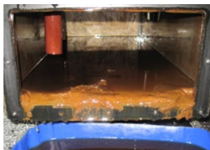
Осадок в баке, вызванный старением масла
