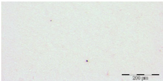
Класс ISO 15/13/10 – требование к маслу для сервоклапанов
