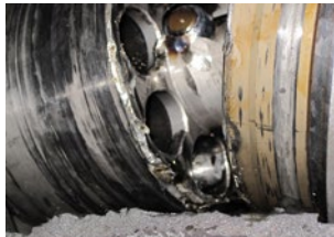
Повреждение аксиально-поршневого насоса вследствие наличия загрязнений в масле
