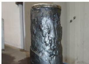
Загрязнение системного фильтра вследствие отслоений внутри шлангов
