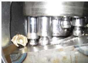
Повреждение аксиально-поршневого насоса вследствие кавитации
